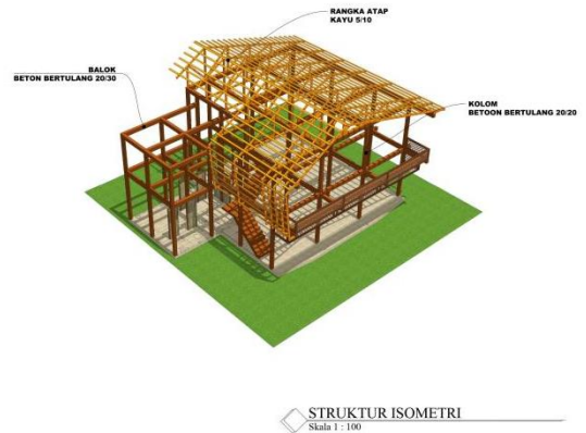
Gambar 12. Isometri Struktur Lobby Sumber: Hasil Rancangan
