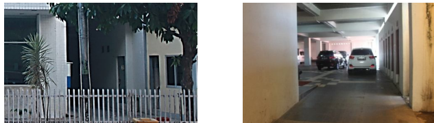
Gambar 2. Sirkulasi parkir kendaraan di dalam yang hanya mempunyai satu jalur keluar masuk dengan lebar 3,5m. Bisa dikatakan hanya bisa dilewati oleh 1 jenis kendaraan. Sumber : dokumentasi pribadi.
