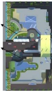
Untuk area pedestrian terbuat dari paving stone untuk memudahkan resapan air kedalam tanah. Jalan mobil terbuat dari aspal sehingga perkerasannya tidak semua bersifat masif.
