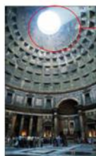
Pemanfaatan sinar matahari sebagai pencahayaan alami Gambar 32 Pantheon Roma Sumber: Tropical Sustainable Architecture
