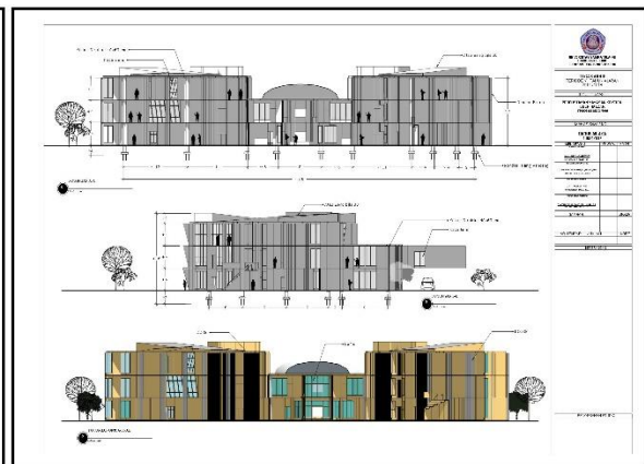
Struktur bangunan menggunakan struktur beton bertulang, dengan besar kolom 40x60cm, tebal plat lantai 15 cm. Tinggi bangunan per lantai 4m, total tinggi bangunan 12m
