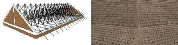
Gambar 6.5 Rangka Atap Baja Ringan & Material atap Sirap
