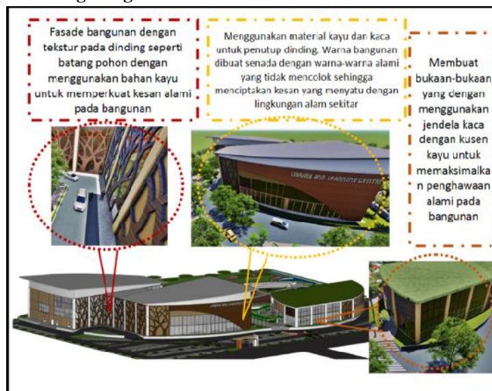
Gambar 4. 3 Konsep Selubung Bangunan
