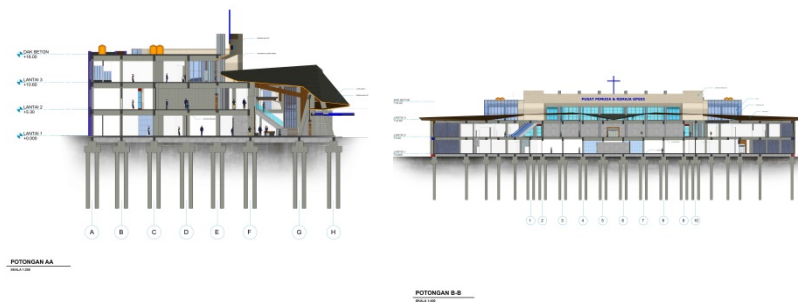
Gambar 15. Potongan Bangunan Sumber: Johana Carolina Siliwire, 2021
