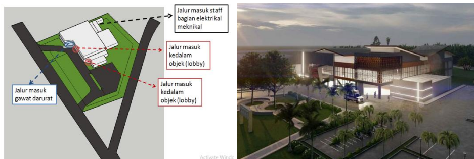
Gambar 11. Perletakan Zona Akses Penghubung Ruang Dalam Dengan Ruang Luar (Sumber : Hasil Perancangan Oleh: Priscilia Lalenoh 2020 )
