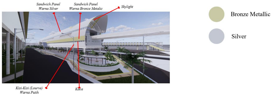
Gambar 3 Selubung Bangunan Stasiun LRT Terpadu Sumber : Dokumen Pribadi, 2022.
