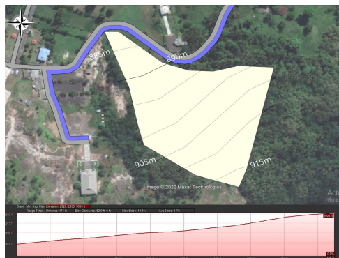
Gambar 2. Konsep Pematangan Lahan (Elevasi Kontur)
