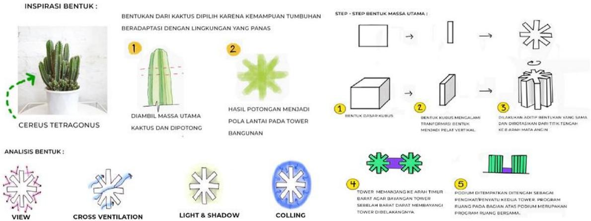
Gambar 6. Konsep Konfigurasi Geometrik Massa Bangunan Utama
