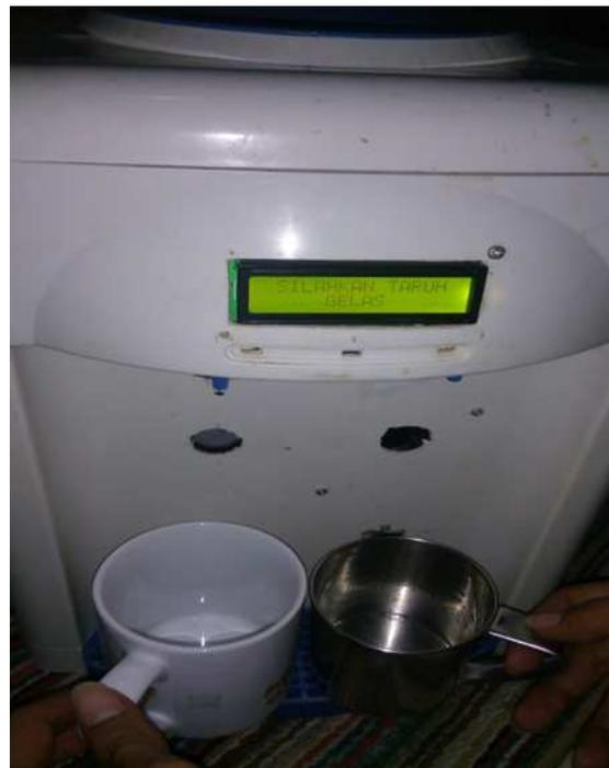
Gambar 24. Pengujian Gelas Diletakan Pada Kedua Kran Dalam Waktu Bersamaan
