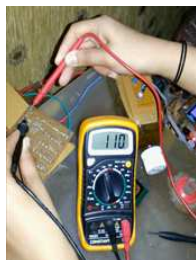
Gambar 31. Pengukuran tegangan keluaran flyback transformator.
