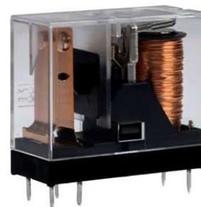
Gambar 6. Bentuk fisik dari Relay
