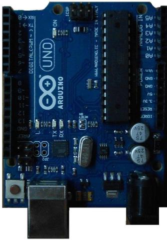
Gambar 7. Gambar Rangkaian nyata Mikrokontroler ATmega328 (Arduino Uno)
