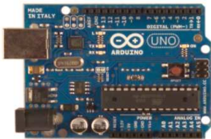
Gambar 5 Bentuk fisik Arduino UNO328
