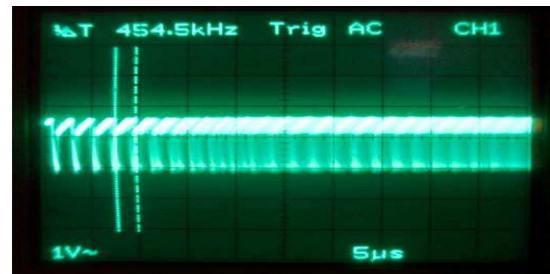
Gambar 8. Bentuk Frekuensi Audio Pada Output Modulator Dan Osilator Sesudah Dimodulasi Dengan Frekuensi Pembawa (Osilator)
