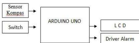
Gambar 5. Diagram Blok Rangkaian
