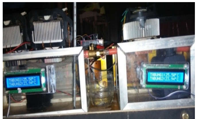
Gambar 4. Tabung radiator pendinginan bertingkat
