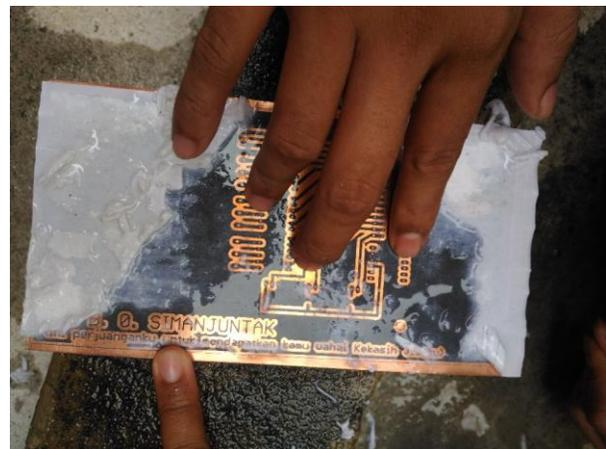
Gambar 4. Proses pengelupasan lapisan tembaga
