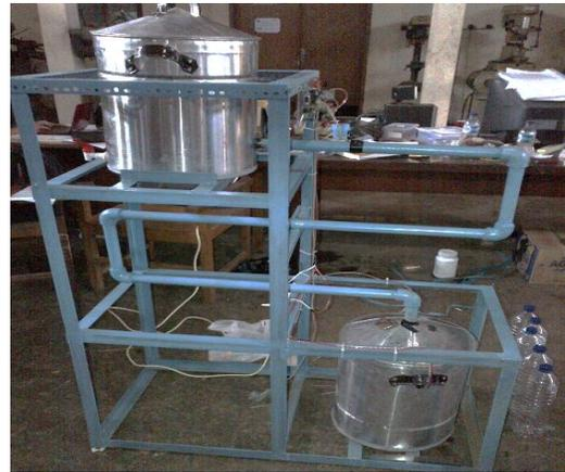
Gambar 23. Konstruksi Mesin Destilasi
