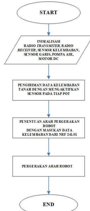
Gambar 11. Diagram alir program utama robot
