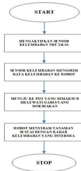
Gambar 12. Diagram alir proses penyiraman robot
