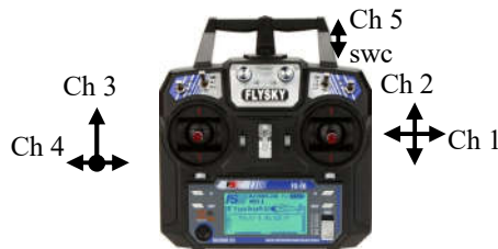
Gambar 28. Tuas dan swc pada Remote
