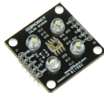
Gambar 9. Bentuk Fisik TCS 3200
