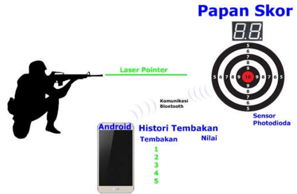
Gambar 16. Prinsip kerja simulasi menembak berbasis arduino uno
