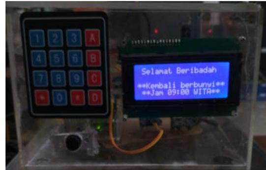
Gambar 13 tampilan LCD pada saat bunyi lonceng 2 ibadah Raya
