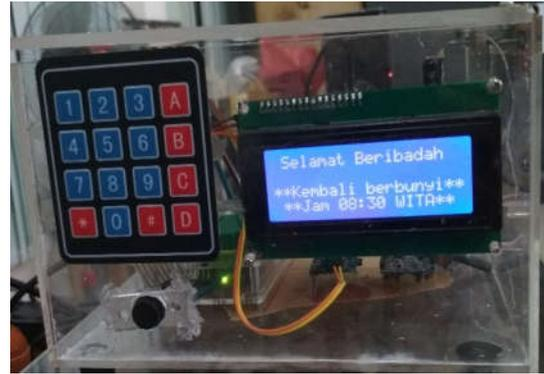
Gambar 12 tampilan LCD pada saat bunyi lonceng 1 ibadah Raya
