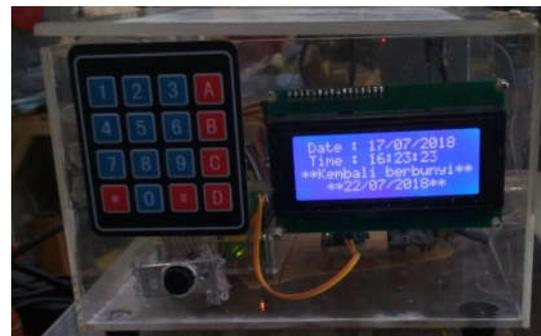
Gambar 14 tampilan LCD pada saat bunyi lonceng 3 ibadah Raya
