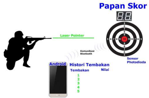
Gambar 16. Prinsip kerja simulasi menembak berbasis arduino uno
