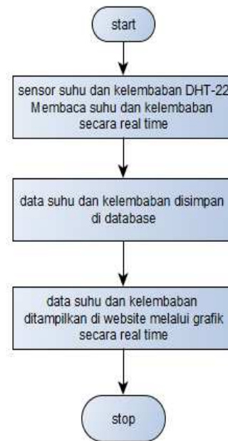
Gambar 7. Diagram alir untuk monitoring suhu dan kelembaban pada ruangan pengering
