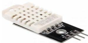
Gambar 3. Sensor DHT 22
