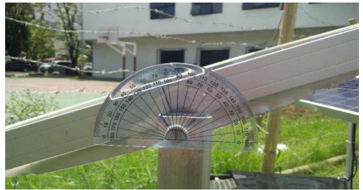
Gambar 16. Hasil pergerakan sudut motor terhadap matahari
