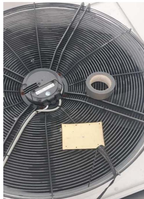
Gambar 13 Peletakan sensor IR di *cooling water*
