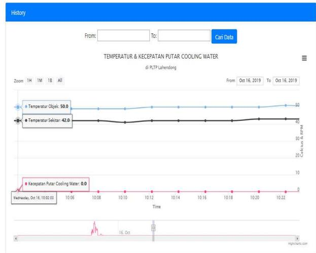
Gambar 19 Temperatur dan kecepatan putar *cooling water* 10.00 AM
