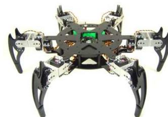
Gambar 2. Sistem Kaki Pada Robot Hexapod
