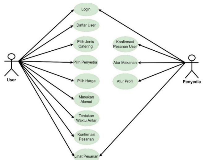
Gambar 4. Use case Diagram Aplikasi Catering Berbasis Mobile
