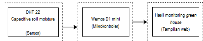
Gambar 9. Diagram blok komponen penyusun sistem monitoring green house
