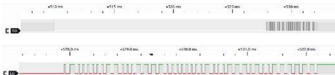
Gambar 26. Diagram waktu data *signal* dari DHT22
