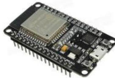
Gambar 3 Mikrokontroler DOIT ESP32 DEVKIT VI
