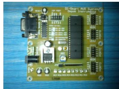
Gambar 3. Modul DI-Smart tempat tertancapnya AVR ATmega 8535
