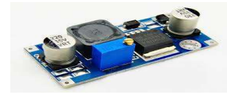
Gambar 10. Bentuk Fisik Stepdown Lm2596
