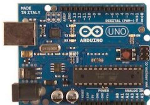
Gambar 6. Bentuk fisik *board arduino UNO*
