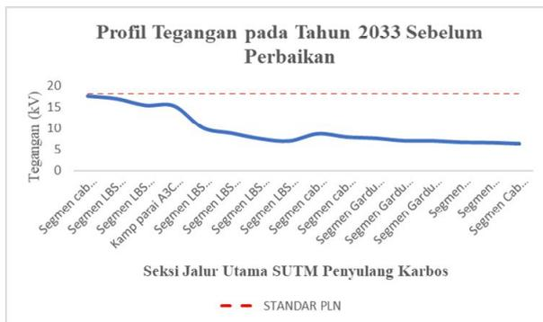
Gambar 4. Profil Nilai Tegangan pada Penyulang Karbos
