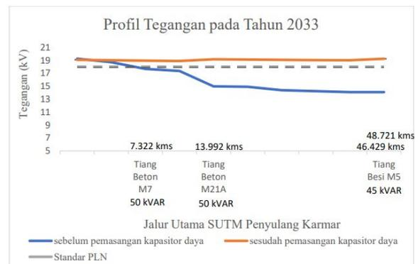
Gambar 7. Profil Tegangan Setelah Pemasangan Kapasitor pada Penyulang Karmar
