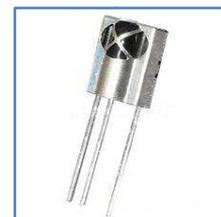
Gambar 3. Sensor TSOP1738
