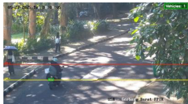
Gambar 8 Hasil Deteksi Kendaraan dan Pembacaan Plat Nomor pada Video 3
