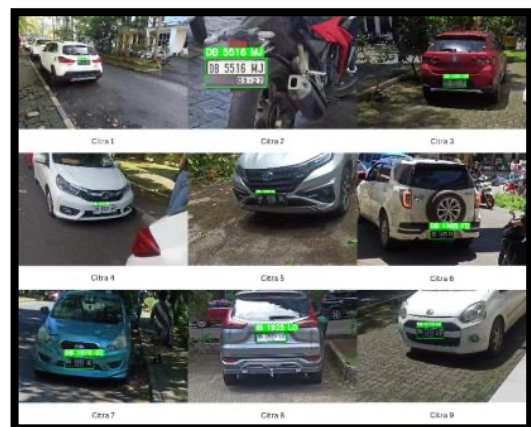
Gambar 5 Hasil pembacaan OCR pada sampel citra plat nomor kendaraan
