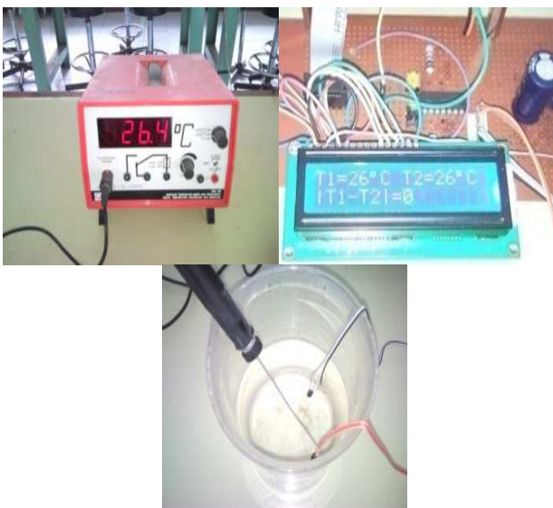
Gambar 21. Perbandingan LM35 dan termometer digital
