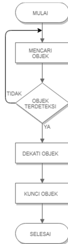
Gambar 11. Diagram Alir Sistem Pendeteksian
