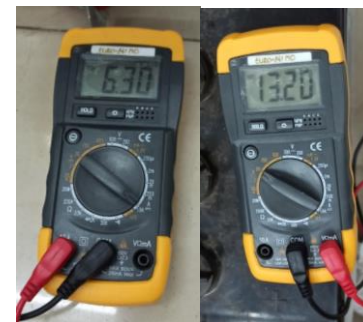
Gambar 12. Arus dan Tegangan pompa
