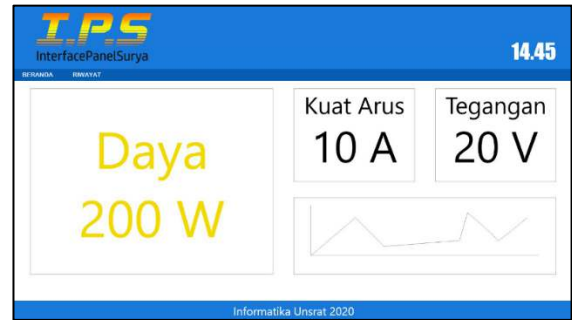
Gambar 6. Konsep awal desain interface monitoring daya listrik dari panel surya menu Beranda
