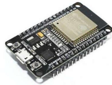
Gambar 1 Mikrokontroler ESP32
