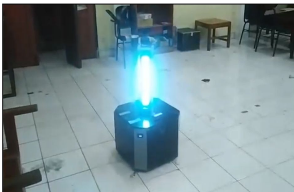
Gambar 11. Robot UV dengan LED ON
