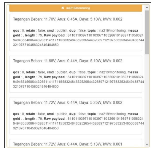
Gambar 3.18 Pengiriman Data INA219 pada Broker MQTT
